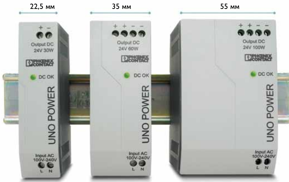
Рисунок 3 – Монтажная ширина источника питания UNO POWER 24V/30Вт, равная 22,5 мм, позволяет экономить место в распределительном шкафу
