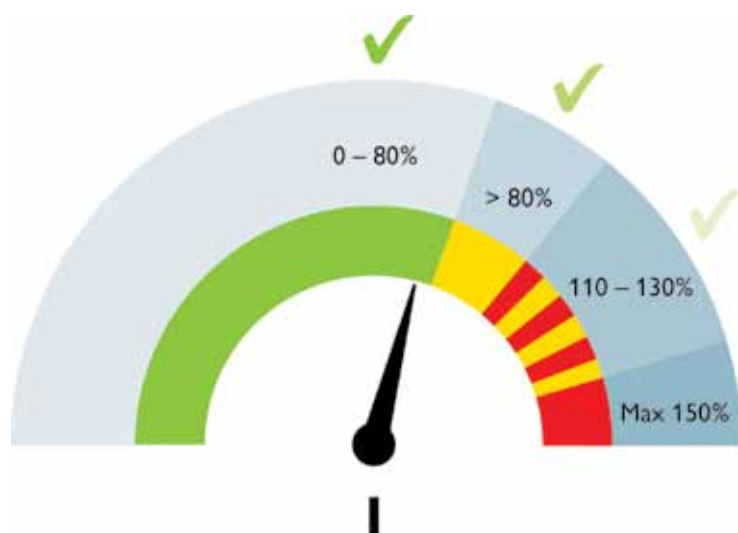
Рисунок 1 – Состояния индикатора канала СВМ в зависимости от значения тока в цепи нагрузки: Зеленый = нормальный режим работы Желтый = сигнал о превышении 80% от установленного значения тока Желтый / Красный = перегрузка Красный = короткое замыкание
