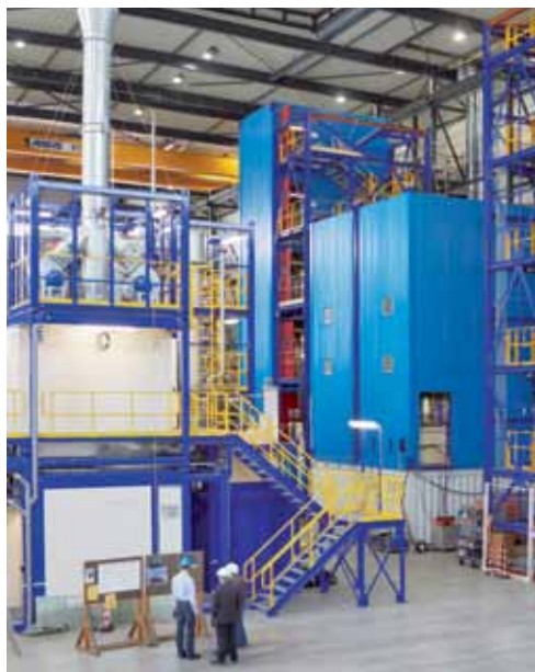
Рисунок 2 – Опытно-эксперимен- тальная установка представляет собой детальное воспроиз- ведение коммерче- ской установки – от клапанов до системы управления производ- ственным процессом
